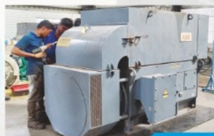
700 KW - 2P - 11KV - ABB
